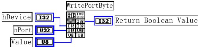
**功能:** 以单字节(8Bit)方式写 I/O 端口。
