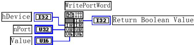
**功能:** 以双字(16Bit)方式写 I/O 端口。
