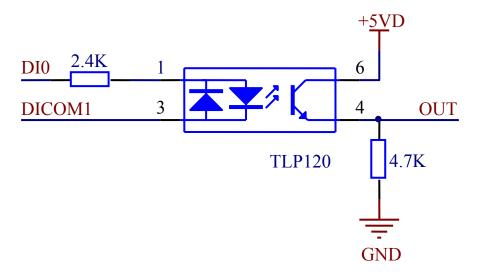
当公共端 DICOM1 接地时,DIO 输入高电平,光耦导通,输出信号 OUT 为高电平; DIO 输入低电平,光 耦不导通,则 OUT 输出为低电平。当 DICOM1 接电源正端时,DIO 输入低电平,光耦导通,输出信号 OUT 为高电平; DIO 输入高电平,光耦不导通,则 OUT 输出为低电平。
