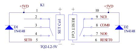
当程序选择继电器 0 开时,继电器内部开关从 NC0 端断开,吸合到 NO0 端,COM0 端与 NO0 端连接;当程序选择继电器 0 关时,继电器内部开关从 NO0 端断开,吸合到 NC0 端,COM0 端与 NC0 端连接。
