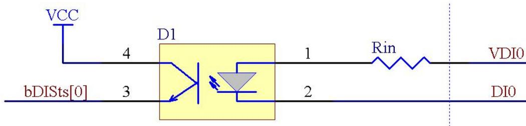
图中虚线右边的为输入信号(DI0)及其参考电压(VDI0)。其工作原理为：当 DI0 输入为高电平时，光耦 D1 的 1、2 脚之间（即 VDI0 与 DI0 之间）无压差，内部无电流，则发光二极管不发光，无法使内部的三极管导通，即 D1 的 3、4 脚之间未连通，则 3 脚的输出信号 bDISts[0]为低电平；当 DI0 输入为低电平时，D1 的 1、2 脚之间有压差，则内部会有电流通过发光管使其发光，使内部三极管导通，即 D1 的 3、4 脚连通，则 3 脚的输出信号 bDISts[0]变为高电平。
