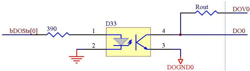
图中虚线右边的为输出信号(DO0)及外接电源(DOV0)。其工作原理为：当用户在软件里置 bDOSSts[0]为高电平时，光耦 D33 的 1、2 管脚之间有压差，则内部会有电流通过发光管使其发光，使内部三极管导通，即 D33 的 3、4 脚连通，使得 4 脚的输出信号 DO0 被 3 脚地信号变成低电平信号；反之 bDOSSts[0]为低电平时，D33 的 1、2 管脚之间无压差，内部无电流，则发光二极管不发光，无法使内部的三极管导通，即 D33 的 3、4 脚之间未连通，则 4 脚的输出信号 DO0 则被 DOV0 拉成高电平。
