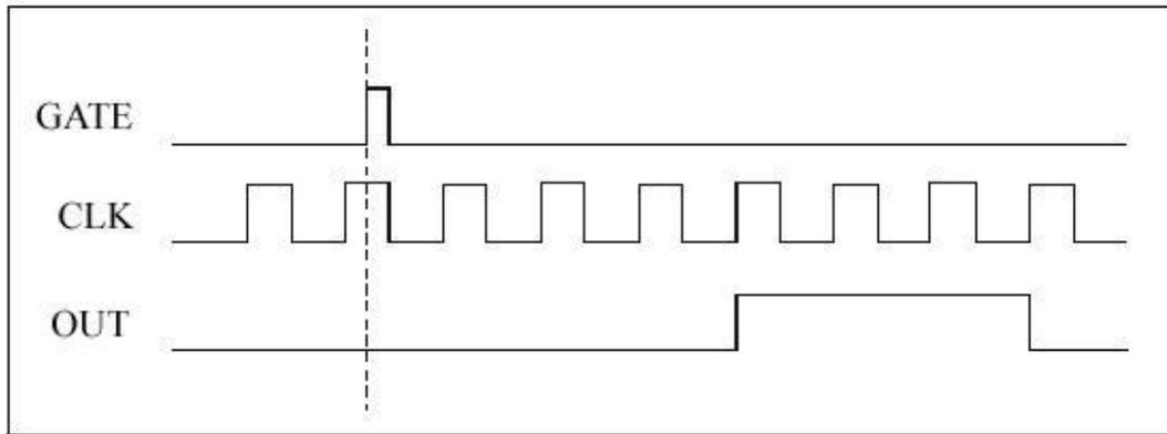
当用户写入指定的计数初值和脉冲宽度并允许计数后，当GATE有一个上边沿时，发生器的输出OUT便会进入一个低电平延时过程，延时时间由用户写入的计数初值参数决定，延时结束后便会输出一个高电平，高电平的延时时间由用户写入的脉冲宽度参数决定，之后，输出一直保持为低电平，其间GATE的其他边沿无效，后续边沿也无效。此方式相当于由外界硬件条件的上边沿启动一个脉冲的发生。
