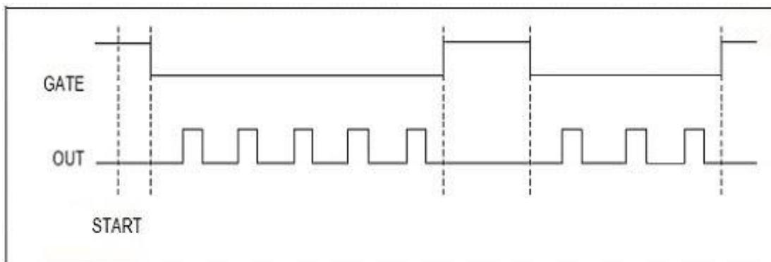
当用户写入指定的计数初值和脉冲宽度，并允许计数后，当GATE为低电平时，发生器的输出OUT便会自动进入一个低电平延时过程，延时长度由用户写入的延时参数决定，延时结束后便会输出一个高电平，高电平的延时时间由用户写入的脉冲宽度参数决定，然后又进入低电平延时过程，产生连续的指定频率和占空比的脉冲串。当GATE为高电平时，则OUT输出立即复位到初始状态。若GATE再出现低电平时，则OUT又继续输出。此方式相当于由外界硬件条件的下边沿启动连续脉冲输出且由单边低电平状态保持脉冲输出允许状态。
