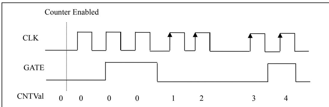
当用户写入初值并允许计数后，只有当GATE由高变为低即产生一个下边沿时，计数器才从初值开始对CLK的上边沿进行加“1”计数，后续GATE变化无效，以此类推。此方式下，相当于使用GATE门上的第一个下边沿作为计数器的启动信号。
