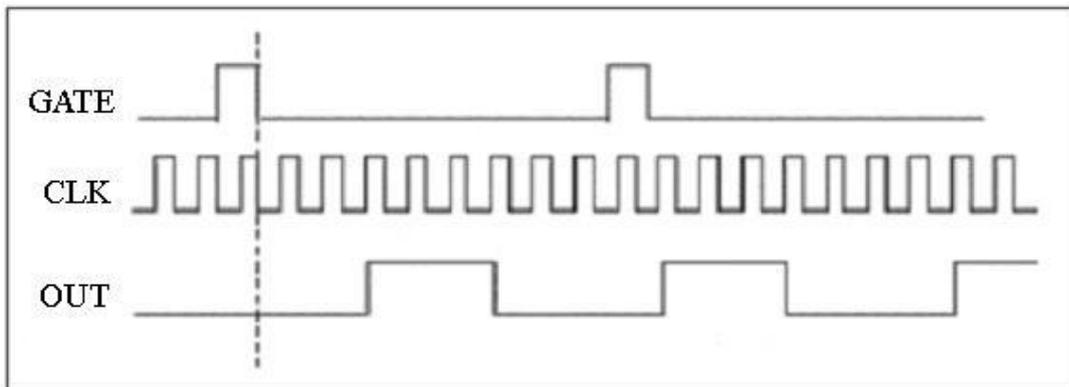
当用户写入指定的计数初值和脉冲宽度，并允许计数后，当GATE上有一个下边沿时，发生器的输出OUT便会进入一个低电平延时过程，延时时间由用户写入的计数初值参数决定，延时结束后便会输出一个高电平，高电平的延时时间由用户写入的脉冲宽度参数决定，然后又进入低电平延时过程，产生连续的指定频率和占空比的脉冲串，后续GATE的其他边沿无效。此方式相当于由外界硬件条件的第一下边沿启动后续连续脉冲的发生。
