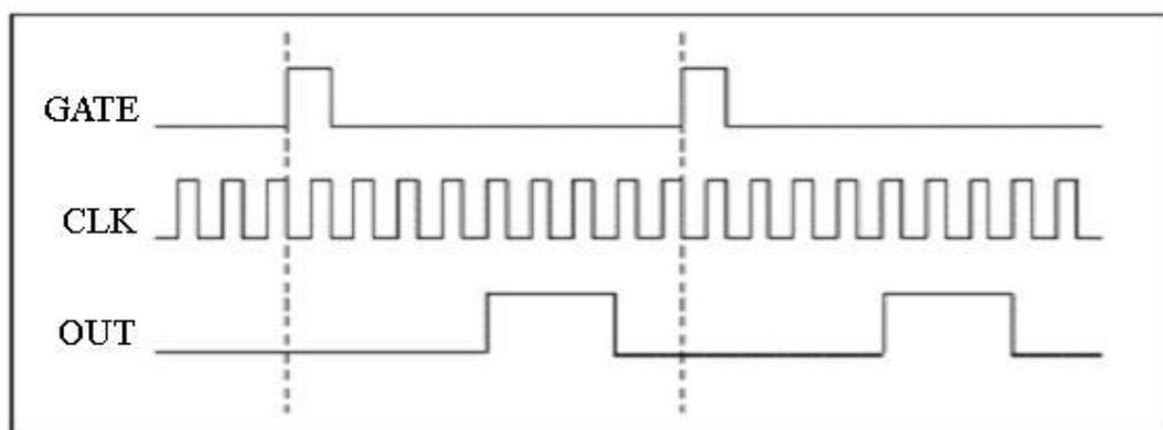
这种方式类似于方式1，只是要重复受到GATE的控制。当用户写入指定的计数初值和脉冲宽度，并允许计数后，当GATE有一个上边沿时，发生器的输出OUT便会进入一个低电平延时过程，延时时间由用户写入的计数初值参数决定，延时结束后便会输出一个高电平，高电平的延时时间由用户写入的脉冲宽度参数决定，其间GATE的其他边沿无效。之后，输出一直保持为低电平。此后若再遇到GATE有上边沿，则又进入下一个脉冲输出。以
