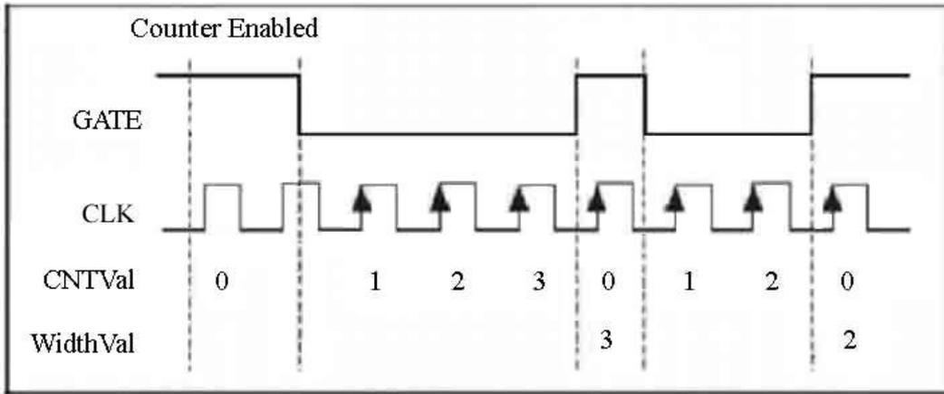
当用户允许计数后, 当GATE为低电平时, 计数器从0开始对CLK的上边沿进行加“1”计数, 当GATE变为高电平时, 锁存计数值到缓冲寄存器中, 以供用户读出, 同时清除计数值。当GATE再变为低电平时, 计数器从0开始加“1”计数, 变为高时锁存计数值到缓冲寄存器, 依此类推。
