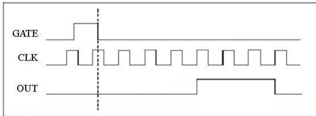
当用户写入指定的计数初值和脉冲宽度，并允许计数后，当GATE有一个下边沿时，发生器的输出OUT便会进入一个低电平延时过程，延时时间由用户写入的计数初值参数决定，延时结束后便会输出一个高电平，高电平的延时时间由用户写入的脉冲宽度参数决定，之后，输出一直保持为低电平，其间GATE的其他边沿无效，后续边沿也无效。此方式相当于由外界硬件条件的下边沿启动一个脉冲的发生。
