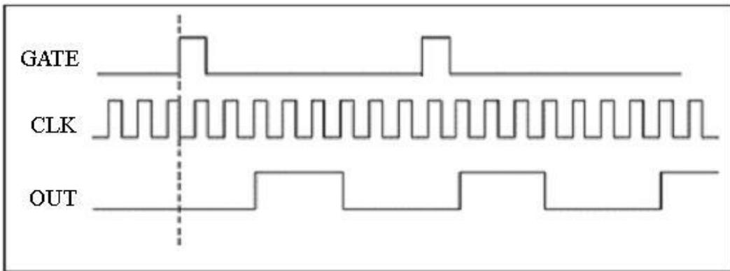
当用户写入指定的计数初值和脉冲宽度并允许计数后，当GATE上有一个上边沿时，发生器的输出OUT便会进入一个低电平延时过程，延时时间由用户写入的计数初值参数决定，延时结束后便会输出一个高电平，高电平的延时时间由用户写入的脉冲宽度参数决定，然后又进入低电平延时过程，产生连续的指定频率和占空比的脉冲串，后续GATE的其他边沿无效。此方式相当于由外界硬件条件的的第一上边沿启动后续连续脉冲的发生。
