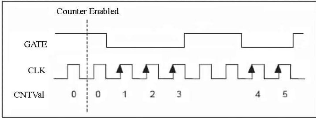
当用户写入初值并允许计数后，当 GATE 为低电平时，计数器才从初值开始对 CLK 的上边沿进行加“1”计数，当 GATE 为高电平时，停止计数且计数值保持不变，若 GATE 再为低时，接着前面保持的计数值继续加“1”计数，以此类推。此项功能用于有单边条件的计数。
