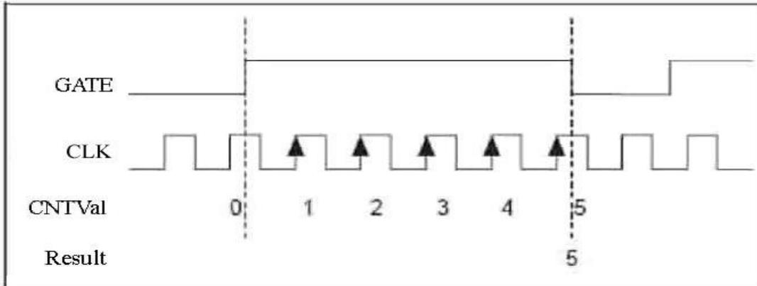
当用户写入初值并允许计数后，当 GATE 产生上边沿时，计数器才从初值开始对 CLK 的上边沿进行加“1”计数，直到 GATE 产生下边沿时停止计数。GATE 后续变化无效。此项功能用于测量正脉冲的宽度。
