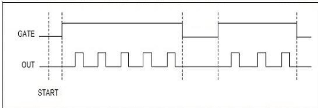
当用户写入指定的计数初值和脉冲宽度，并允许计数后，当GATE为高电平时，发生器的输出OUT便会自动进入一个低电平延时过程，延时长度由用户写入的延时参数决定，延时结束后便会输出一个高电平，高电平的延时时间由用户写入的脉冲宽度参数决定，然后又进入低电平延时过程，产生连续的指定频率和占空比的脉冲串。当GATE为低电平时，则OUT输出立即复位到初始状态。若GATE再出现高电平时，则OUT又继续输出。此方式相当于由外界硬件条件的上边沿启动连续脉冲输出且由单边高电平状态保持脉冲输出允许状态。
