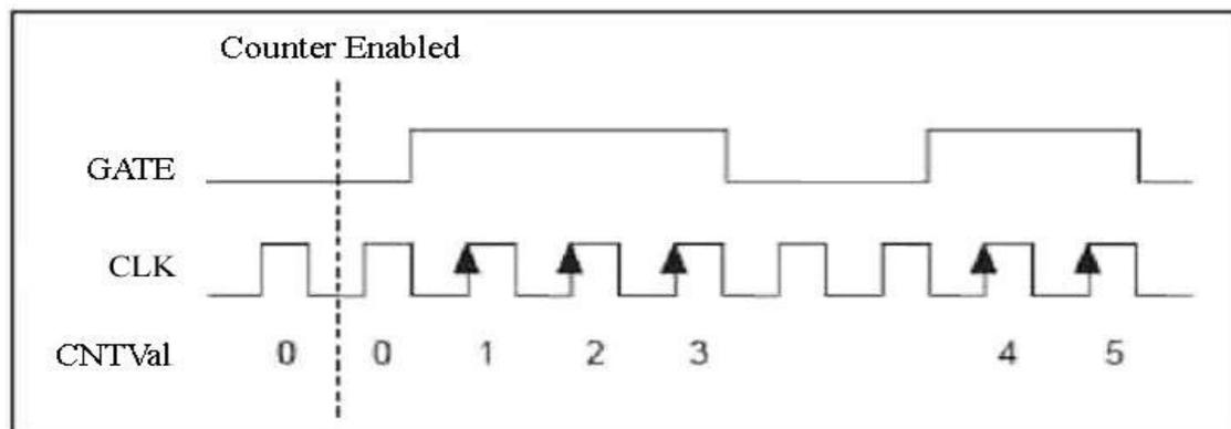
当用户写入初值并允许计数后，当 GATE 为高电平时，计数器才从初值开始对 CLK 的上边沿进行加“1”计数，当 GATE 为低电平时，停止计数且计数值保持不变，若 GATE 再为高时，接着前面保持的计数值继续加“1”计数，以此类推。此项功能用于有单边条件的计数。
