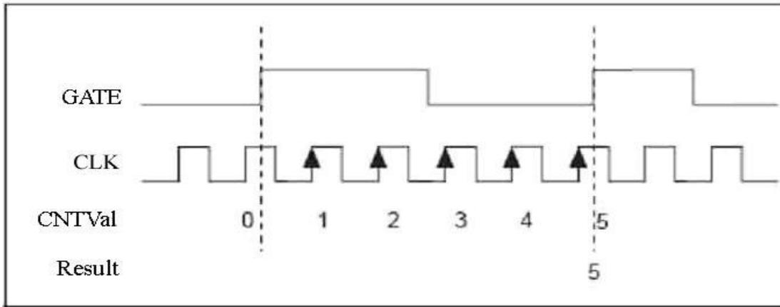
当用户写入初值并允许计数后，当 GATE 产生上升沿时，计数器才从初值开始对 CLK 的上边沿进行加“1”计数，直到 GATE 再次产生上升沿时停止计数。GATE 后续变化无效。此项功能用于测量脉冲的整周期宽度。
