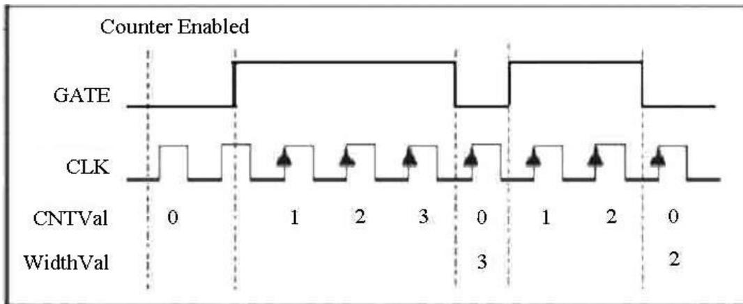
当用户允许计数后，则GATE为高电平时，计数器从0开始对CLK的上边沿进行加“1”计数，当GATE变为低电平时，锁存计数值到缓冲寄存器中，以供用户读出，同时清除计数值。当GATE再变为高电平时，计数器从0开始加“1”计数，变为低时锁存计数值到缓冲寄存器，依此类推。
