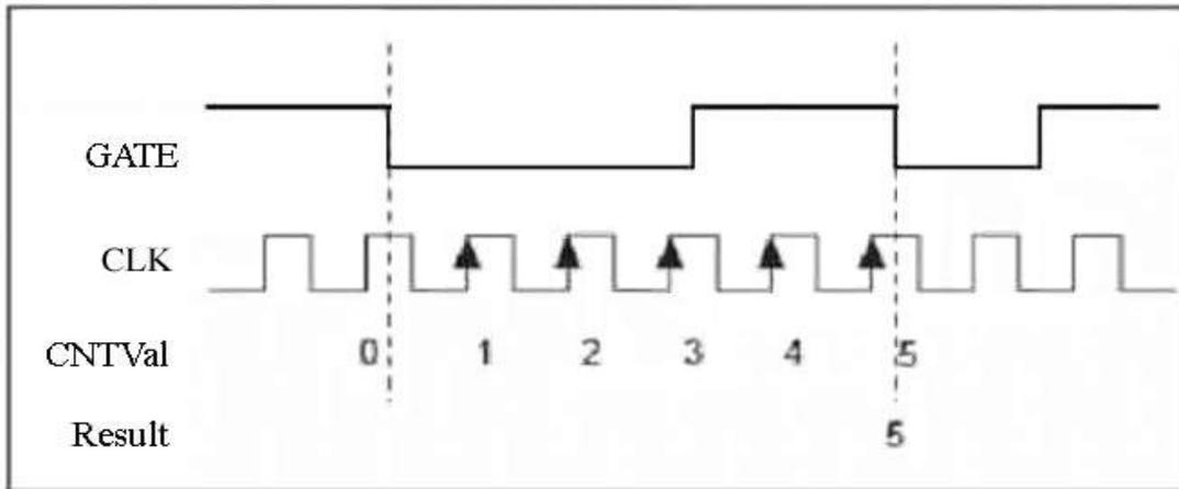
当用户写入初值并允许计数后，当 GATE 产生下降沿时，计数器才从初值开始对 CLK 的上边沿进行加“1”计数，直到 GATE 再次产生下降沿时停止计数。GATE 后续变化无效。此项功能用于测量脉冲的整周期宽度。
