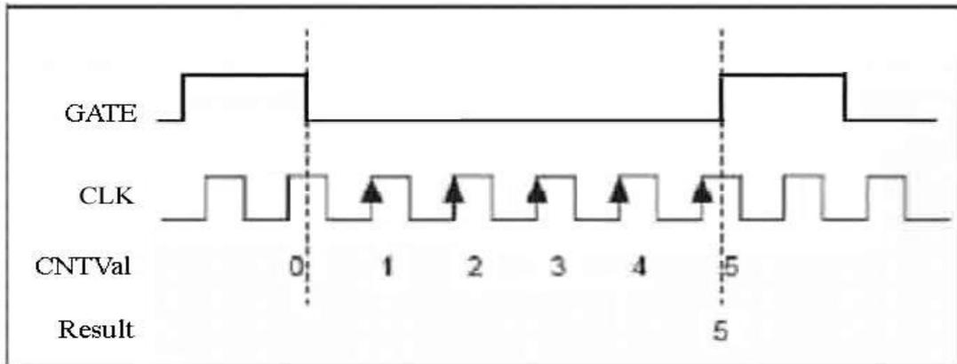
当用户写入初值并允许计数后，当 GATE 产生下降沿时，计数器才从初值开始对 CLK 的上边沿进行加“1”计数，直到 GATE 产生上升沿时停止计数。GATE 后续变化无效。此项功能用于测量负脉冲的宽度。应将被测信号接入 CN1 的 GATE 脚，时钟基准信号可以从 CN1 的 CLK 脚输入（也可选用本地时钟 LOCAL\_CLK），建议在保证计数器不溢出的情况下尽可能使用较高的时钟基准以提高测量精度。
