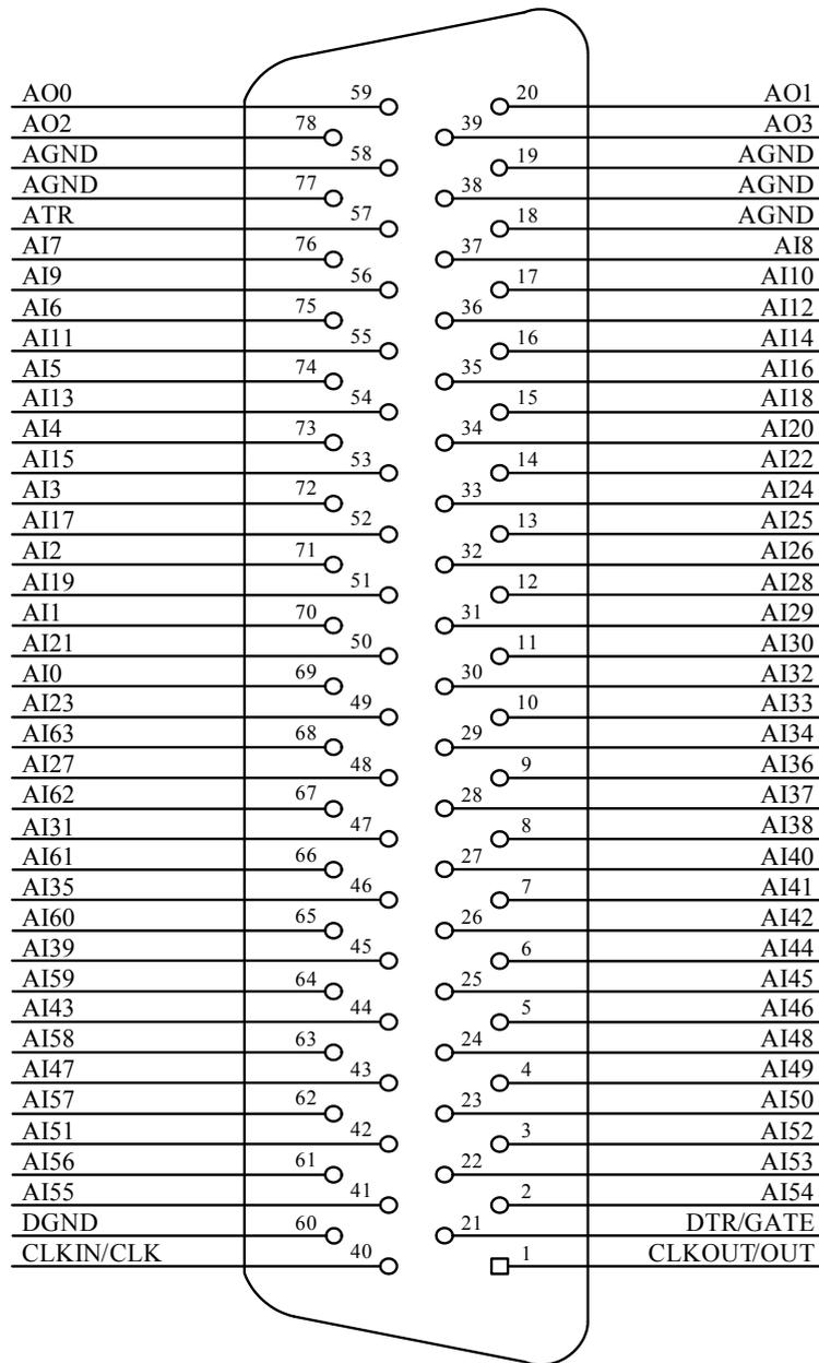
管脚说明：CLKIN/CLK、CLKOUT/OUT 和 DTR/GATE 三个管脚为复用管脚。当使用 AD 功能时，上述管脚功能分别作为 CLKIN、CLKOUT 和 DTR 使用；当使用定时/计数器功能时，上述管脚功能分别作为 CLK、OUT 和 GATE 使用，各管脚功能定义见下表：
