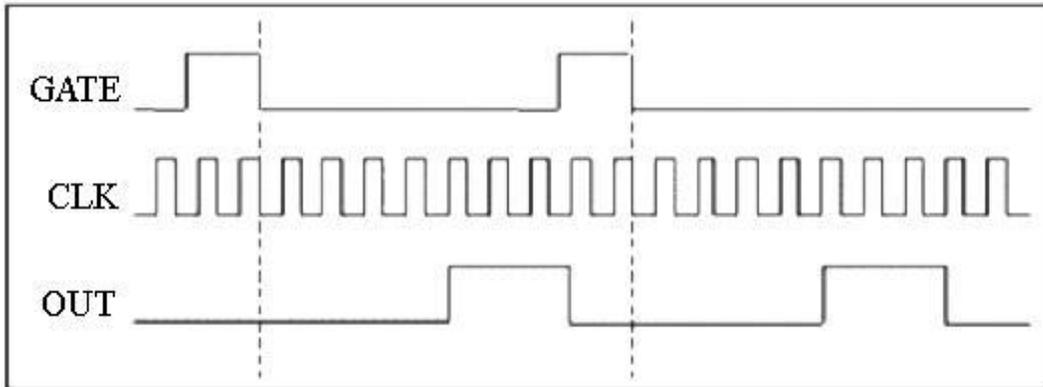
这种方式类似于方式2，只是要重复受到GATE的控制。当用户写入指定的计数初值和脉冲宽度，并允许计数后，当GATE有一个下边沿时，发生器的输出OUT便会进入一个低电平延时过程，延时时间由用户写入的计数初值参数决定，延时结束后便会输出一个高电平，高电平的延时时间由用户写入的脉冲宽度参数决定，其间GATE的其他边沿无效。之后，输出一直保持为低电平。若再遇到GATE有下边沿，则又进入下一个脉冲输出。以此类推。此方式相当于由外界硬件条件的每个下边沿不断启动一个脉冲的发生。
