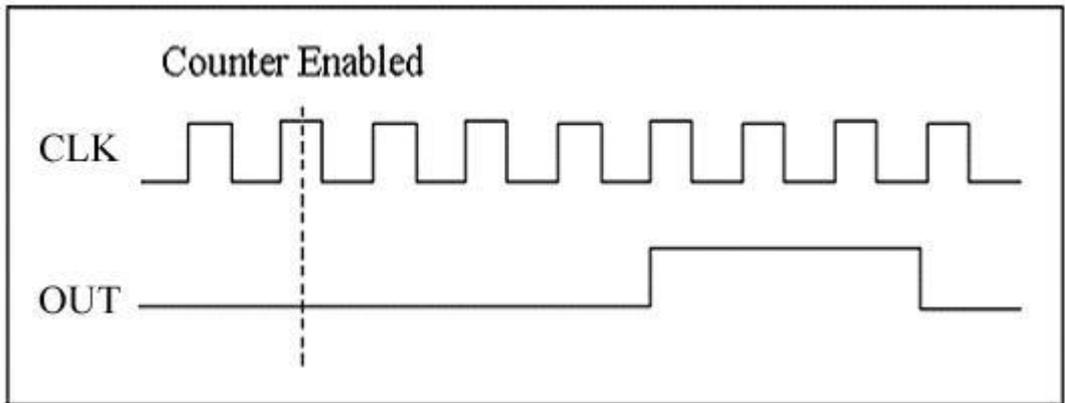
当用户写入指定的计数初值和脉冲宽度，并允许计数后，发生器的输出OUT便会进入一个低电平延时过程，延时时间由用户写入的计数初值参数决定，延时结束后便会输出一个高电平，高电平的延时时间由用户写入的脉冲宽度参数决定，之后，输出一直保持为低电平。此方式相当于由用户软件启动一个脉冲的发生。
