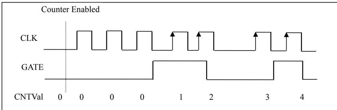
当用户写入初值并允许计数后，只有当GATE由低变为高即产生一个上边沿时，计数器才从初值开始对CLK的上边沿进行加“1”计数，后续GATE变化无效，以此类推。此方式下，相当于使用GATE门上的第一个上边沿作为计数器的启动信号。
