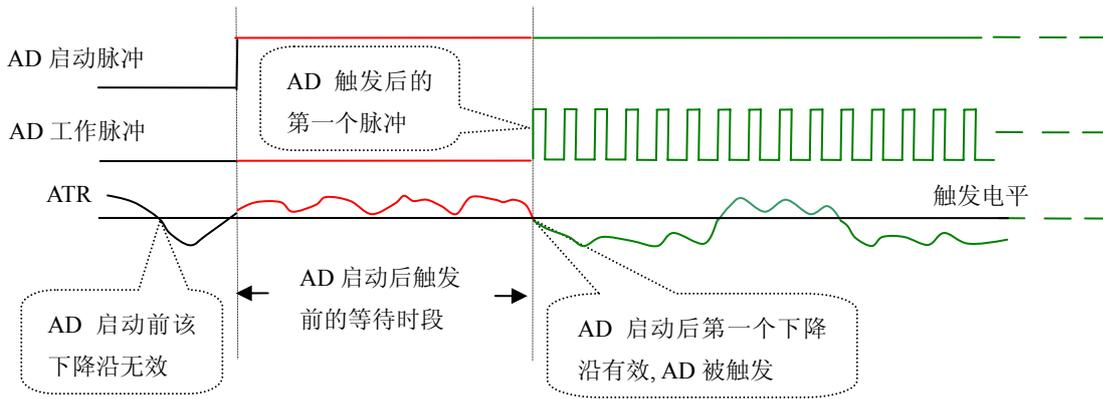
图 6.3 下降沿触发图例，上升沿同理
