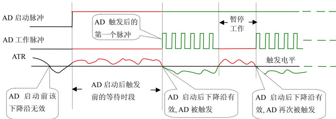
图 6.4 低电平触发
