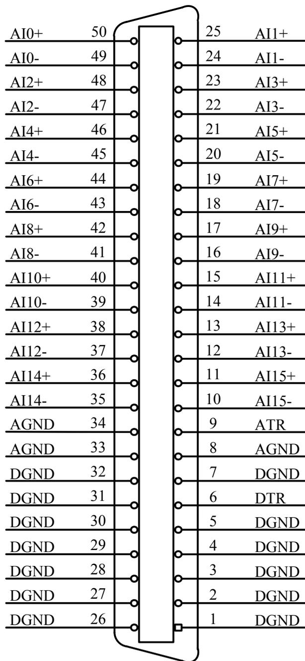
关于50芯D型插头CN1的管脚定义（表格方式）
