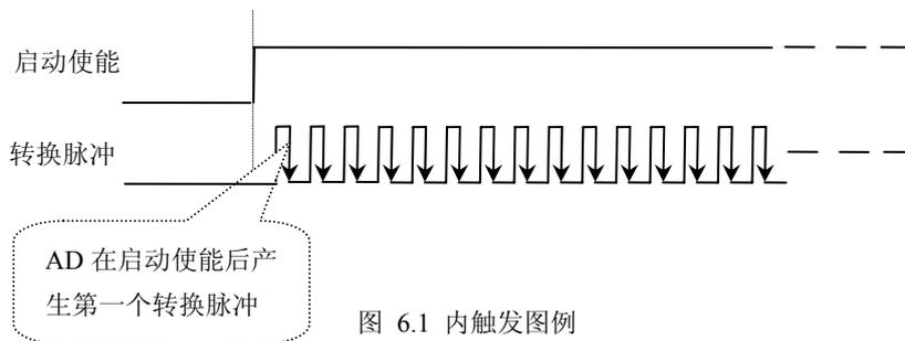
图 6.1 内触发图例
