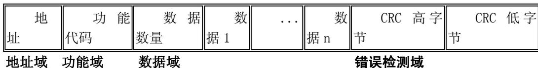
**帧定界：**在 MODBUS RTU 方式下，每两个字符之间发送或者接收的时间间隔不能超过 1.5 倍字符传输时间。如果两个字符时间间隔超过了 3.5 倍字符传输时间，就认为一帧数据已经接收完成，新的一帧数据传输开始。
