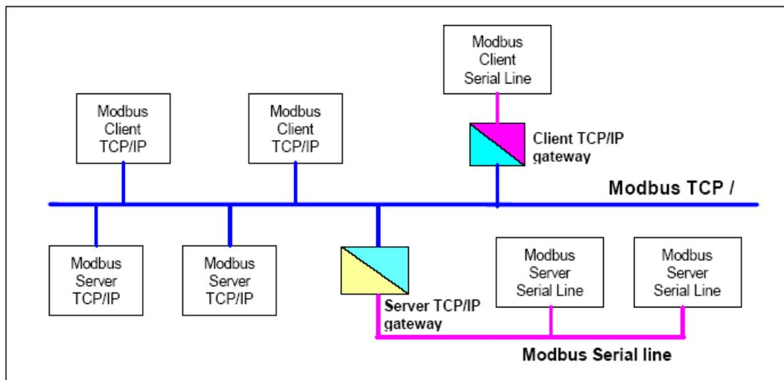
此协议定义了一个控制器能认识使用的消息结构,而不管它们是经过何种网络进行通信的。它描述了控制器请求访问其它设备的过程,如果回应来自其它设备的请求,以及怎样侦测错误并记录。它制定了消息域格局和内容的公共格式。
