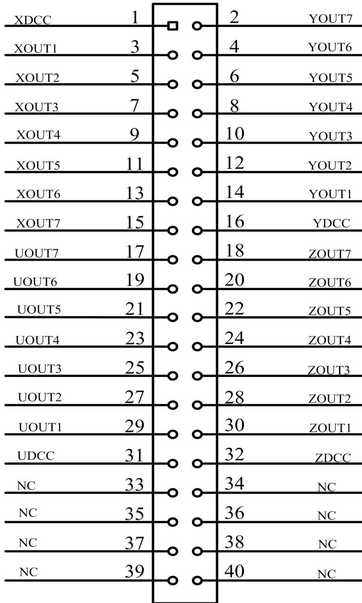
关于 40 芯插头 CN1 的管脚定义 (表格方式):
