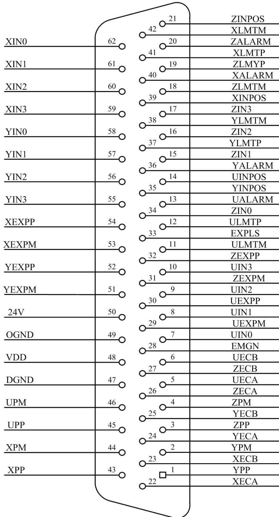
关于 62 芯 D 型插头 CN2 的管脚定义 (表格形方式):
