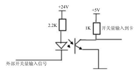
触点型开关量输入
