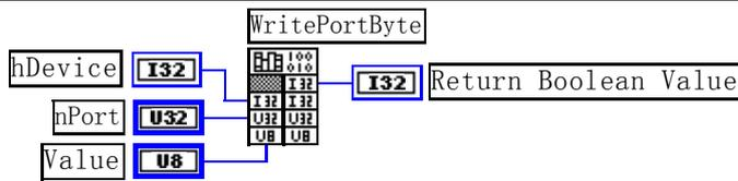
功能：以单字节(8Bit)方式写 I/O 端口。
