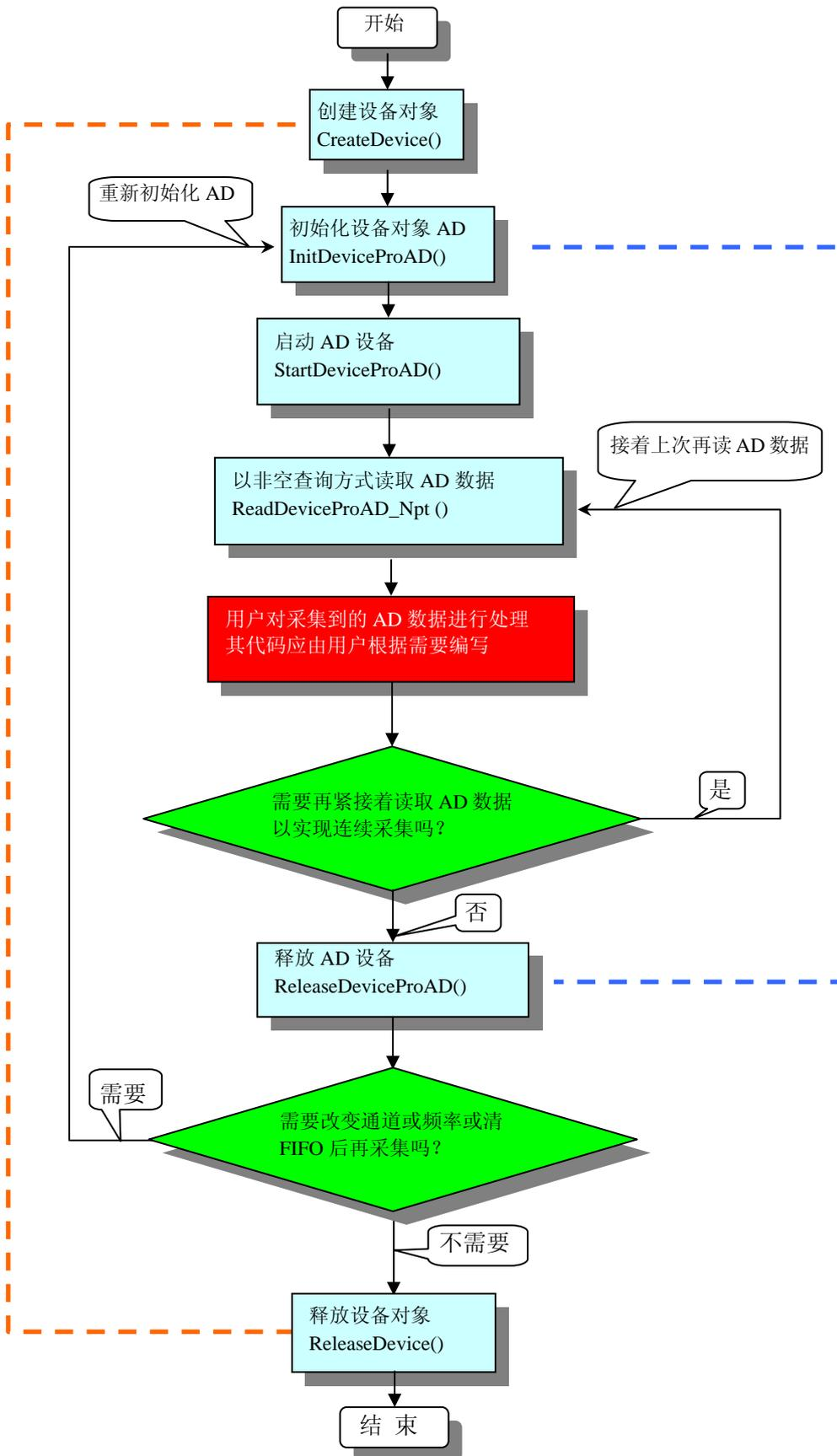
图 2.1.1 非空查询方式 AD 采集过程
