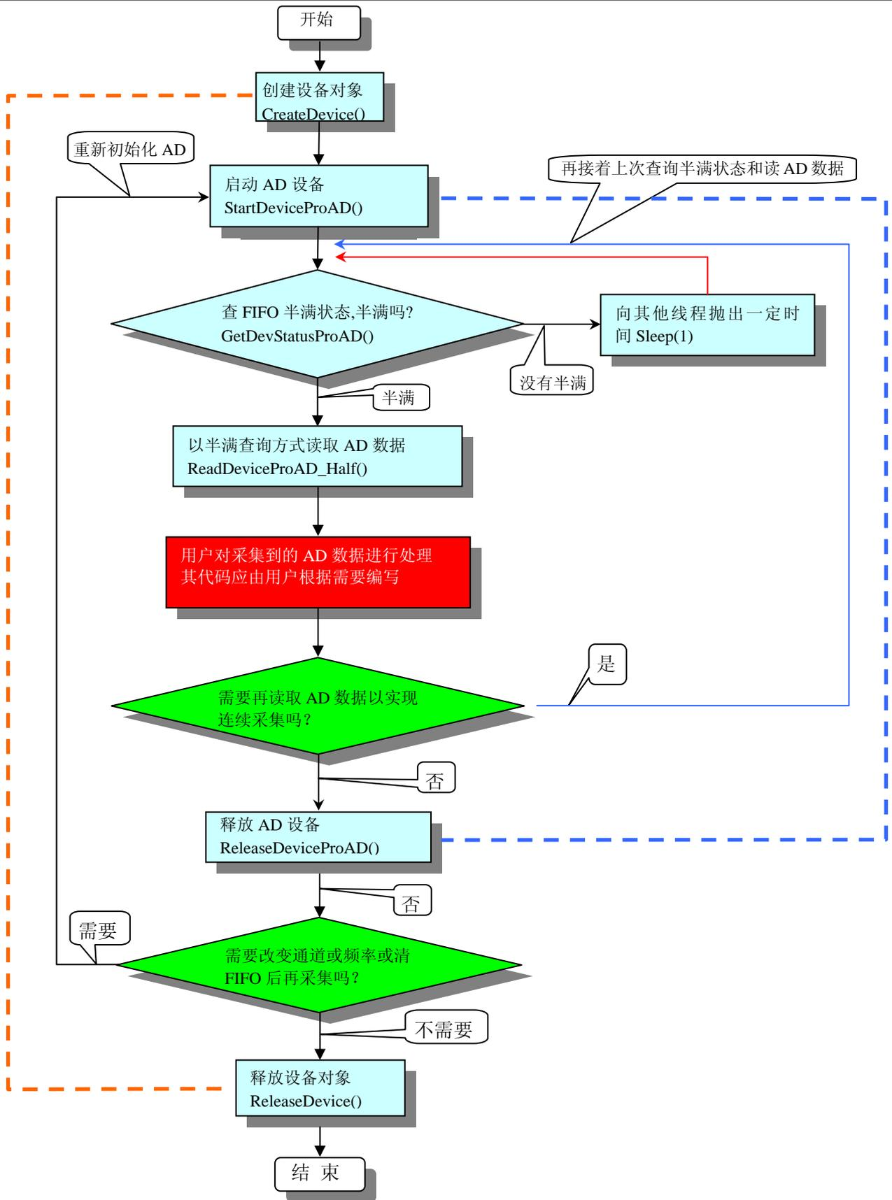
图 2.1.2 半满查询方式 AD 采集过程
